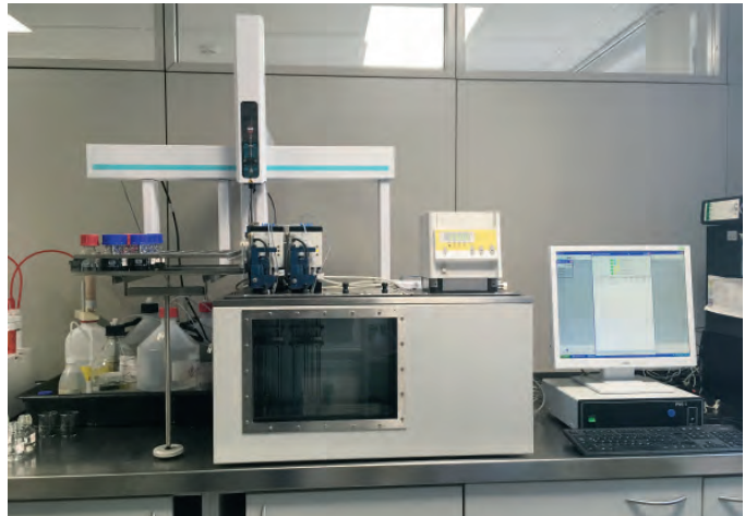
6: Lösungsviskosität: Mittels dieses Verfahrens können Aussagen über die Qualität des gelieferten Rohmaterials und die Güte der Verarbeitung getroffen werden. Dazu wird das getrocknete Probenmaterial in einem geeigneten Lösemittel gelöst und die Durchlaufzeiten durch eine Kapillare im Vergleich zum eingesetzten Lösungsmittel gemessen
